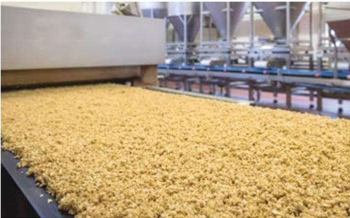
► Unter der Hitze des Netzbandofens entfaltet das Crunchy sein typisches Röstaroma (oben). Nachdem das Crunchy abgekühlt ist, wird es in der Mehrkopfwaaage portioniert (Mitte) und in der Schlauchbeutelanlage abgefüllt (unten).
